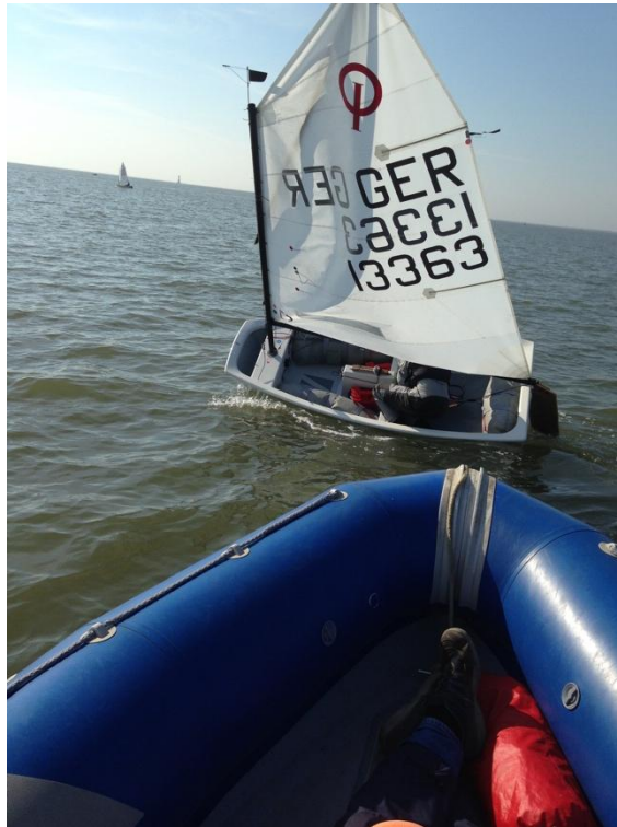
Abbildung 10, Durch das dichtere Segel ist man wieder schneller auf dem Am-Wind-Kurs, um die Schot herum greifen, vorne sitzen bleiben.
