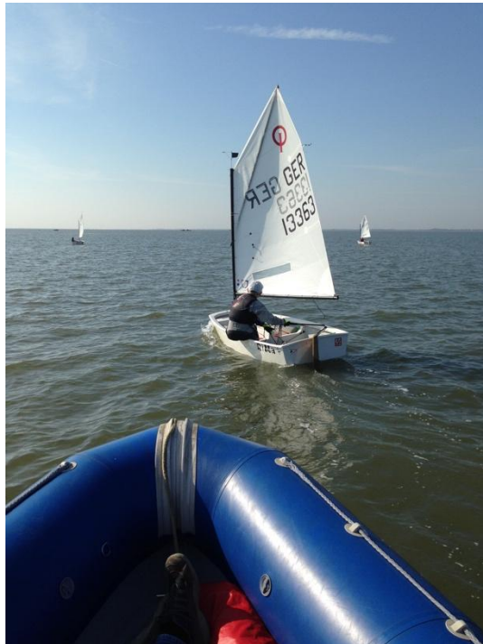
Abbildung 8, Genauer Am-Wind-Kurs, Ruderausschlag ca. 45°, beim Anluven Segel dicht ziehen, Knie bleiben nach vorne eingedreht
